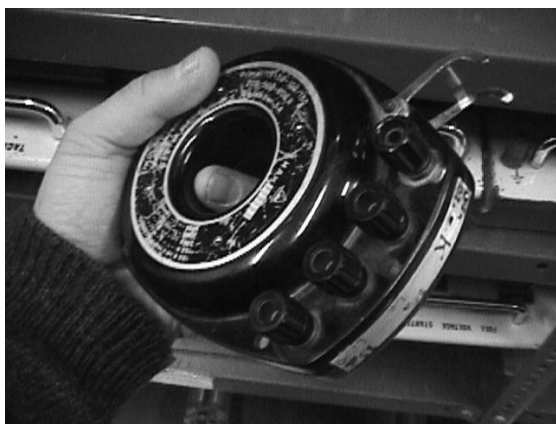
Transformador de corriente típico
