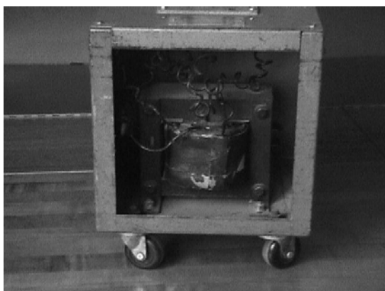
Transformador monofásico de laboratorio
